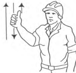
4 Levantar el aguilón o pluma lentamente
