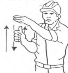
4 Levantar el aguilón o pluma lentamente
